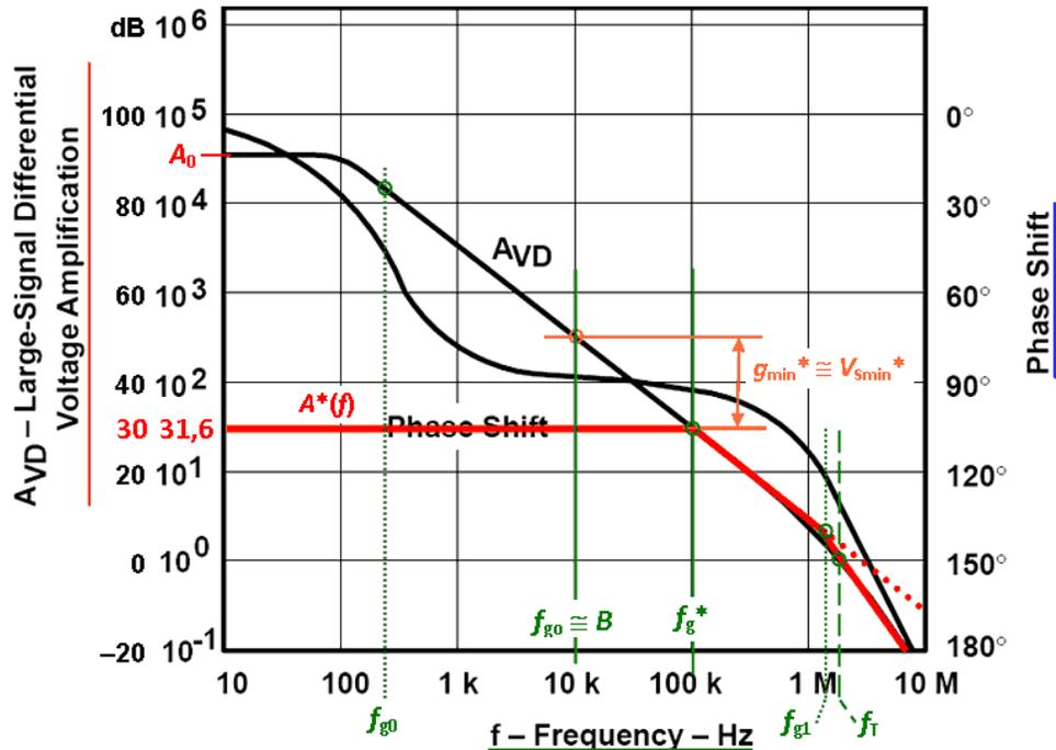
b) abgel.:  $v_{u,prog} \text{ (dB)} = 30 \text{ dB} \rightarrow v_{u,prog} \cong 31,6$ .
