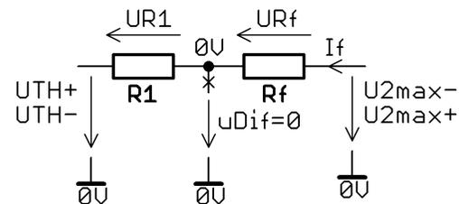
S.T. „kippt“, wenn die Differenz-Eingangsspannung  $u_{Dif}$  das Vorzeichen wechselt  $\leftrightarrow u_1 = U_{TH\pm}$ . Man rechnet mit  $u_{Dif} = 0$  sowie  $U_2$  unmittelbar vor dem „Kippen“.
